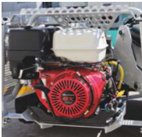
Motor protejat de o structură robustă care evită deteriorarea în cazul căderii de material.
