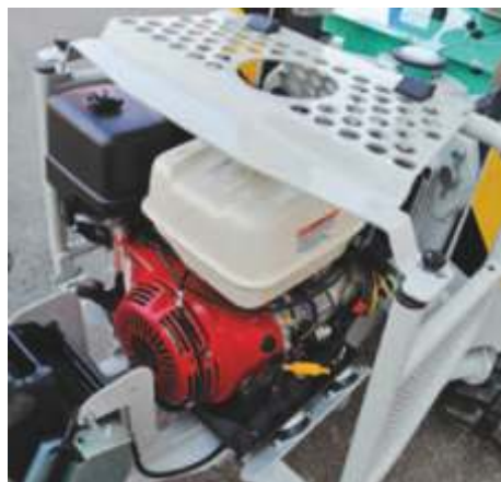
Motor protejat de o structura robustă care evită deteriorarea în cazul căderii de material.
