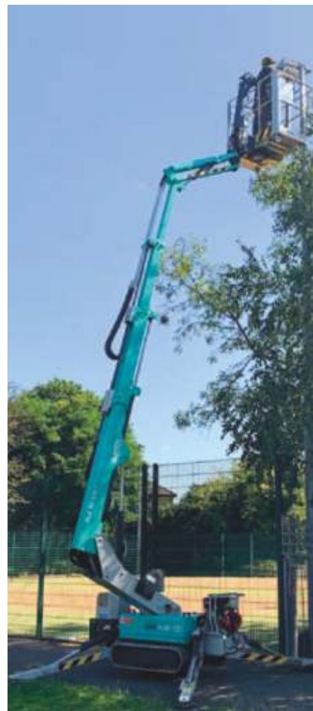
Stabilizarea automată în poziția de lucru asigură ușurință maximă de utilizare și siguranță.
