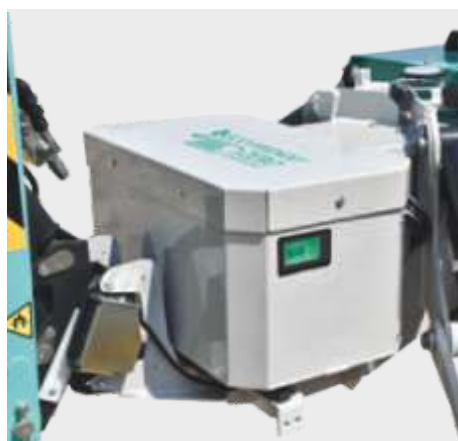
Compartiment pentru baterii cu litiu: protejat și ușor accesibil pentru gestionarea ciclului de încărcare. Afișaj LCD pentru starea de încărcare și durata rămasă a bateriei (IM R 19 SA Litium).
