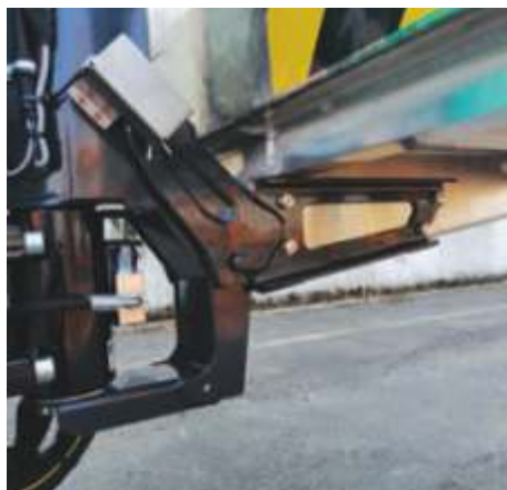
Sistem de montare coș conceput pentru ușurință de asamblare/dezasamblare.
