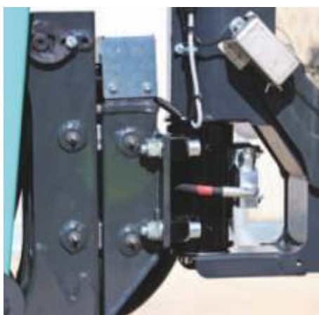
Ansamblu JIB compact care găzduiește celulele de sarcină și grupul de rotație a coșului.
