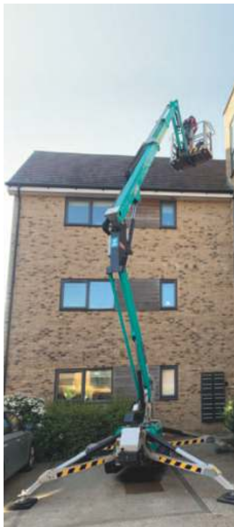
Brațul principal articulat cu braț JIB activ și rotația coșului \pm 62^\circ , împreună cu rotirea turelei la 360^\circ (non continuă), permit poziționarea optimă a utilajului în orice situație de lucru.
