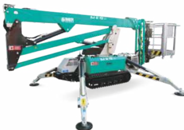
Dimensiune compactă, cu amprenta generală limitată a stabilizatorilor. Stabilizarea automată standard permite poziționarea optimă și rapidă a mașinii.
