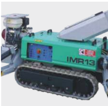
Panou de control ușor de accesat, poziționat în interiorul carcasei utilajului pentru protecție.
