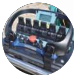
Panoul de control este detașabil și poate fi folosit de către operator chiar și de la sol. În acest caz, mișcările de tracțiune și stabilizare sunt activate atât în varianta radiocomandată (până la o distanță de 10 m), cât și în varianta comandată prin cablu spiralat lung de 5 m.
