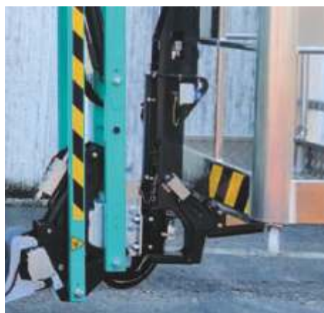
Ansamblul JIB compact care găzduiește celulele de sarcină și grupul de rotație a coșului.
