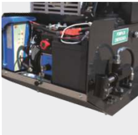
Pompă manuală de urgență și compartiment care găzduiește bateria și controlul electropompei de urgență și conexiunea bateriei.
