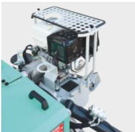
Bloc de alimentare endotermic protejat corespunzător pentru o siguranță îmbunătățită.
